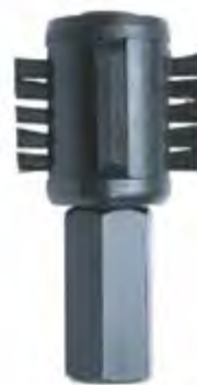
ЩЕТКА-СКРЕБОК РАСШИРЯЮЩАЯСЯ ТИПА "EXS" ДЛЯ УДАЛЕНИЯ ТОНКИХ СЛОЕВ НАКИПИ, САЖИ ИЛИ МЯГКИХ ОТЛОЖЕНИЙ
